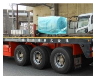
トラック車上の 鋼材荷物の防錆
